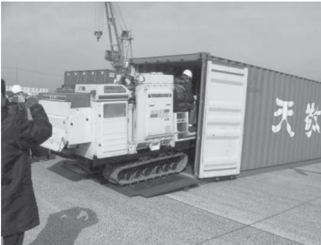
コンテナに積み込む農機（コンバイン）
